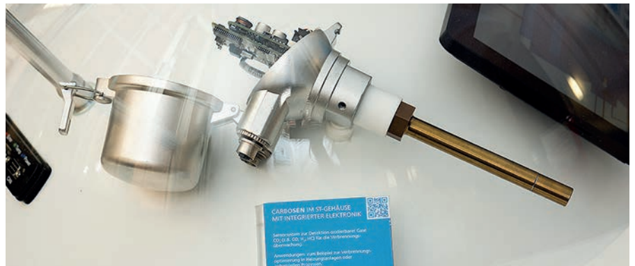
Carbosen – ein Sensorsystem zur Detektion oxidierbarer Gase – zum Beispiel zur Optimierung von Heizungsanlagen
